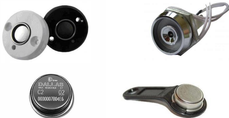
Рисунок 4. Считыватели и ключи iButton
